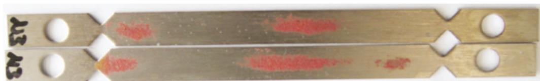
Sehr schmutzig, d.h. min. 2/3 der ursprünglich kontaminierten Oberfläche des Prüfkörpers ist noch mit der Testanschmutzung bedeckt.
