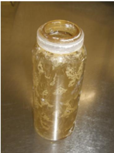
Abb. 7-7 Tränkeflasche mit Prüfanschmutzung
