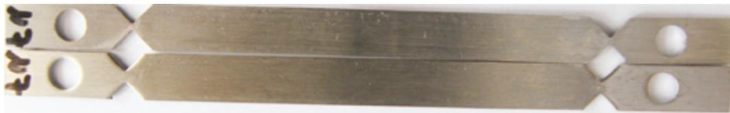
Leicht verschmutzt, d.h. auf der Oberfläche des Prüfkörpers sind geringe Reste der Testanschmutzung vorhanden.
