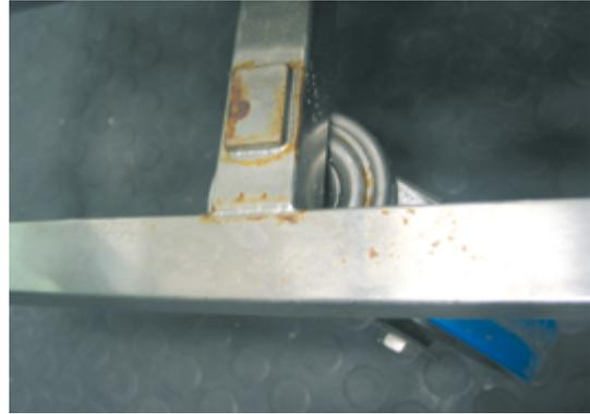
Abb. 9-7 Ansicht Edelstahlgestelle mit Korrosion
