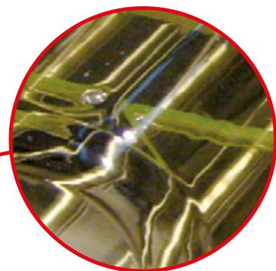
Abb. 7-10 Darstellung Käfig, keine erkennbaren Wasserreste, auch keine Tropfen - Stufe 1
