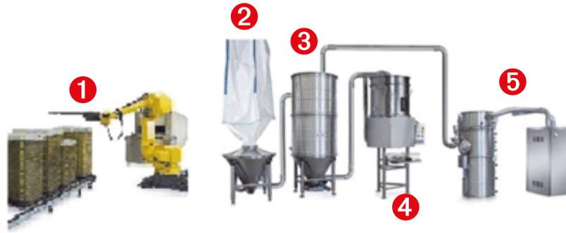
Abb. 4-18 Beispiel eines vollautomatischen Systems: Befüllung der Käfige mit Roboter oder Automaten ①, Befülltrichter saubere Einstreu z. B. mit BIG-Bag ②, optionales Lagersilo ③, Dosierspeicher mit Staubabsaugungseinrichtung ④ und Vakuumerzeuger und Staubfilter ⑤ für die pneumatische Förderung.
