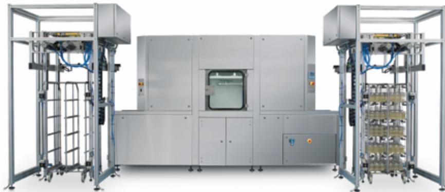
Abb. 4-15: Flaschenreinigungsanlage mit automatischer Beladung der Flaschenkörbe aus einem Transportwagen, Entkappung, Förderung, Reinigung, Befüllung, Bekappung und automatischer Entladung der Flaschenkörbe zurück in einen Transportwagen
