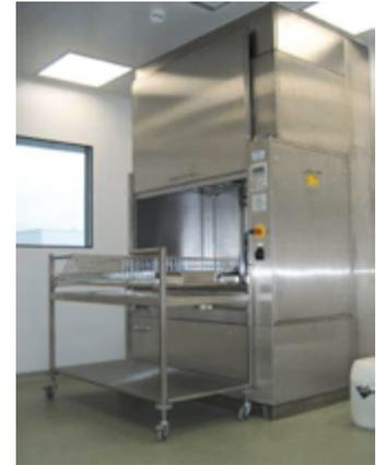
Abb. 4-8: Käfigkabinettreinigungsanlage mit Klapp- oder Schiebetür
