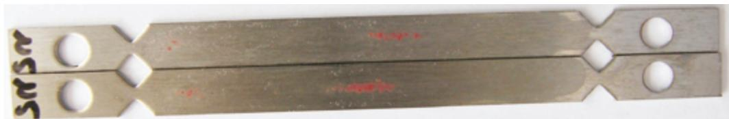
Schmutzig, d.h. 1/3 der ursprünglich kontaminierten Oberfläche des Prüfkörpers ist noch mit der Testanschmutzung bedeckt.
